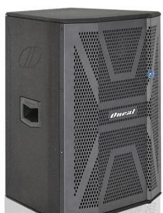
Caixa Ativa c/ 1 Alto Falante de 10" 1 Driver de Titânio, Impedância Nominal 4 Ohms, 2 entradas Line com Jacks P10 1/4" com controle de volume , Suporte Tipo Copo Para Pedestal, Alças Laterais para Transporte. SPL MÁX. CONTÍNUO - Campo Livre 106dB, SPL MÁX. PICO - Plano ao Terra 124dB.
