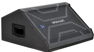
Monitor Ativo c/ 1 Alto Falante de 12" 1 Driver de Titânia, Impedância Nominal 8 Ohms, 2 entradas Line, sendo 1 com Jack P10 1/4" e uma outra com XLR Femea, com controle de volume, Alças Laterais para Transporte. SPL MÁX. CONTÍNUO - Campo Livre 103dB, SPL MÁX. PICO - Plano ao Terra 121dB.
