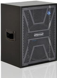
Cx. Ativa, 2 Vias c/ 1 A.F 10" e driver , C/. 2 entr. Line com Jacks P10 1/4" com controle de volume, 1 saída P10 para caixa passiva, proteção conta curto na saída (SCP-Short Circuit Protection) e função Limiter (CLP-Clip Limiter Protection) , ALÇAS PARA TRANSPORTE E SUPORTE PARA PEDESTAL.. OB 1310 X vendido em separado. (SPL MAX CONTINUO Campo livre 105bB / SPL MAX PICO Plano Terra 123dB).
