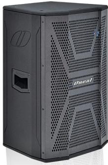
Cx Ativa, 2 Vias c/ 01 A F 10" e 1 Driver TI,Novo DCL - Duplo Limiter com rendimento superior, ICS/ARP/SCP/ETP/SPOT/EQ3Vias, 01 Ent. Linha (P10/XLR) e 01 Ent. de Mic (XLR) C/Vol. Independentes. 4 Pontos de parafuso olhal M8 (SPL MAX CONTINUO Campo livre 111bB / SPL MAX PICO Plano Terra 129dB).
