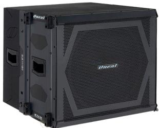
Cx. Ativa Bass Reflex Classe D, c/ 01 A F 18", Resposta de frequência 30Hz à 200Hz e Ajuste de Corte do Crossover 70Hz a 200Hz, ARP/ETP/CLP/BI/PHI/ Chave Lift Gnd (aterramento), Tensão de rede automática 110/220 , Alças Laterais, Ferragem c/ suporte para Quick Pins que tem fixação por cordão de aço( fixo) e Tela de Metal e Nova pintura .(SPL MAX CONTINUO Campo Limpo 113,0dB / SPL MAX PICO Plano Terra 131,0dB) (NCM 8518.21.00)
