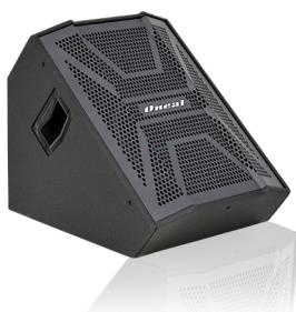
Mon. Ativo com amplificador lateral, 2 Vias c/ 1 A.F 15" e DRIVER , C/. 2 entr. Line com Jacks P10 1/4" com controle de volume, 1 saída P10 para caixa passiva, proteção conta curto na saída (SCP-Short Circuit Protection) e função Limiter (CLP-Clip Limiter Protection), Gabinete de madeira com pintura resinada e Tela de metal X , ALÇAS PARA TRANSPORTE. OBM 1315X vendido em separado. (SPL MAX CONTINUO 117,0bB / SPL MAX PICO Plano Terra 123,0dB )
