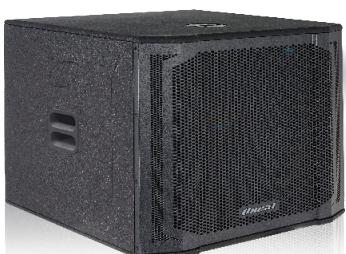
Cx. Ativa Band Pass, Classe D, dB SPL MÁX. CONTÍNUO - Campo Livre 115dB / dB SPL MÁX. CONTÍNUO - Plano ao Terra 121dB / dB SPL MÁX. PICO - Campo Livre 127dB / dB SPL MÁX. PICO - Plano ao Terra 133dB / Classe D / 1 Alto Falante de 15"
