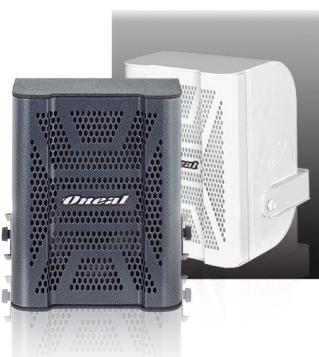
Caixa ativa c/ 2 vias. 1 A.F. de 8' + Tweeter, c/ 2 entradas paralelas Line(P 10), função limiter (CLP - Clip Limiter Protection), Chave seletora 120V/220V, Tela de metal, Suporte para pedestal e parede. Cor preta. (SPL MAX CONTINUO Campo Livre 105dB / SPL MAX PICO Plano Terra 123dB). (NCM 8518.22.00)
