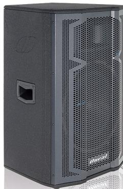
Caixa Ativa, Classe D, dB SPL MÁX. CONTÍNUO - Campo Livre 116dB / dB SPL MÁX. CONTÍNUO - Plano ao Terra 122dB / dB SPL MÁX. PICO - Campo Livre 128dB / dB SPL MÁX.PICO - Plano ao Terra 134dB / Resposta de freqüência (55Hz à 18KHz) / Ângulo de cobertura (60°H x 40°V) / Classe D / 1 Alto falante de 12" / 1 Driver de Titânio
