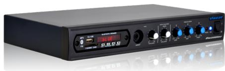
Cabeçote Amplificado com 60W Rms, com 1 entrada para microfone com controle de volume individual; controle de volume para entrada auxiliar RCA Cd/Dvd/MP3/WMA Player com radio FM; entrada USB E CARTÃO SD,BLUETOOTH, Controles de graves, médios e agudos; Controle Remoto. Painel traseiro com entrada auxiliar RCA Cd/Dvd/MP3; bornes para conexão das caixas e antena FM. Chave seletora 120/220V.
