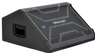
Monitor Ativo c/ 1 Alto Falante de 10" 1 Driver de Titânia, Impedância Nominal 8 Ohms, 2 entradas Line, sendo 1 com Jack P10 1/4" e uma outra com XLR Femea, com controle de volume, Alças Laterais para Transporte. SPL MÁX. CONTÍNUO - Campo Livre 103dB, SPL MÁX. PICO - Plano ao Terra 121dB.
