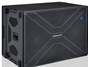
Cx. Ativa Bass Reflex c/ 02 A F 15" , Resposta 35/200Hz e CFA 70 Hz a 200 Hz, ICS/ARP/SCP/ETP/CLP/BI/PHI/ Chave Lift Gnd (aterramento) 110/220Vac, Novas alças Laterais, Nova Ferragem c/ suporte para Quick Pins que tem fixação por cordão de aço ( fixo) e Nova tela e pintura .(SPL MAX CONTINUO Campo Limpo 121,6dB / SPL MAX PICO Plano Terra 139,6dB).. (NCM 8518.22.00)
