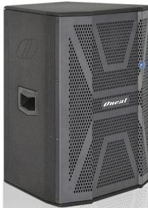
Caixa Ativa c/ 1 Alto Falante de 10" 1 Driver de Titânio, Impedância Nominal 4 Ohms, 2 entradas Line com Jacks P10 1/4" com controle de volume , Suporte Tipo Copo Para Pedestal, Alças Laterais para Transporte. SPL MÁX. CONTÍNUO - Campo Livre 106dB, SPL MÁX. PICO - Plano ao Terra 124dB.
